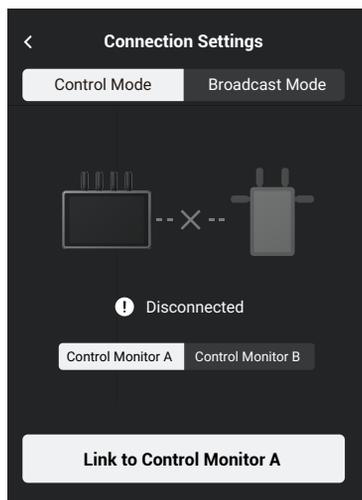
2. Ronin 4Dの使用：リンク接続を開始するには、Ronin 4D映像トランスミッターのリンクボタンを長押しするか、Ronin 4D高輝度メインモニターのメニューに移動し、[Transmission] (伝送)、[Link Device] (デバイスをリンク) の順にタップします。映像トランスミッターのリンク
