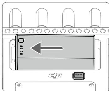
WB37 배터리 분리 버튼을 누른 상태에서 배터리를 반대 방향으로 밀어 분리합니다.
