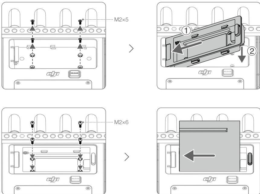
Houd de accu-ontgrendelknop op de accu-adapter ingedrukt en druk de accu in de tegenovergestelde richting om deze te verwijderen.
