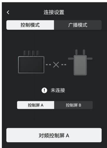
2. 使用 Ronin 4D：在 Ronin 4D 的机身高亮监视器菜单中选择图传设置 > 配对，或长按 Ronin 4D 图传发射器上的对频按键以进入对频状态，此时图传发射器上的对频状态指示灯红绿交替闪烁。
