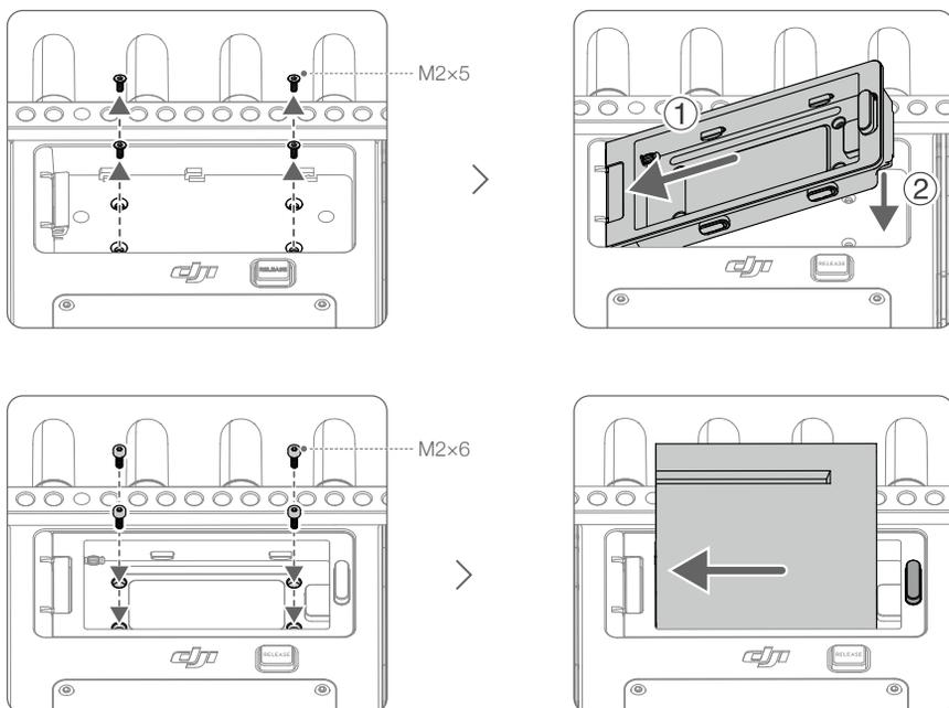
Нажмите и удерживайте кнопку отсоединения аккумулятора на адаптере для аккумулятора и протолкните аккумулятор в противоположном направлении, чтобы снять его.
