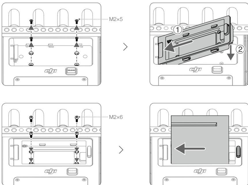
バッテリーを取り外すには、バッテリーアダプターのバッテリー取り外しボタンを押したまま、バッテリーを反対方向に動かして取り外します。
