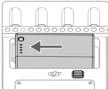
Нажмите и удерживайте кнопку отсоединения аккумулятора WB37 и протолкните аккумулятор в противоположном направлении, чтобы снять его.
