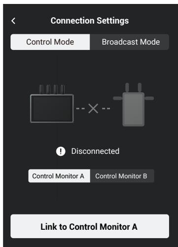
2. Ronin 4D 사용: 연동을 시작하려면 Ronin 4D 영상 송신기의 연동 버튼을 길게 누르거나 Ronin 4D 고 휘도 메인 모니터에서 메뉴로 들어가서 'Transmission(전송)'을 누른 후 'Link Device(기기 연동)'을 누릅니다. 동영상 송신기의 연동 상태 표시등이 빨간색과 녹색으로 번갈아 깜박이며 기기가 연동되고 있음을 나타냅니다.
