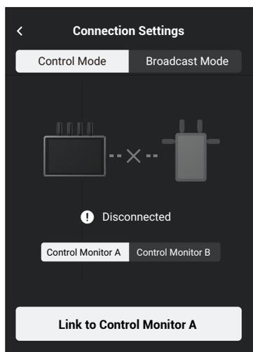
2. Usando el Ronin 4D: para empezar la vinculación, mantenga pulsado el botón de enlace del transmisor de vídeo Ronin 4D o vaya a los menús del monitor principal de alto brillo Ronin 4D, pulse Transmisión y Vincular Dispositivo. El indicador de estado de vinculación del transmisor de vídeo parpadea en rojo y verde alternativamente para indicar que el dispositivo se está vinculando.
