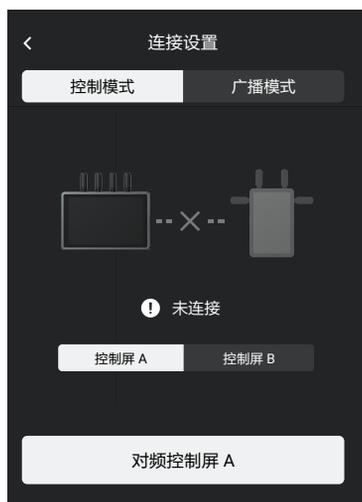
2. 使用 Ronin 4D: 在 Ronin 4D 的機身高亮度監視器選單中選擇影像傳輸設定 > 配對，或長按 Ronin 4D 影像傳輸發射器上的配對按鍵以進入配對狀態，此時影像傳輸發射器上的配對狀態指示燈將紅綠交替閃爍。
