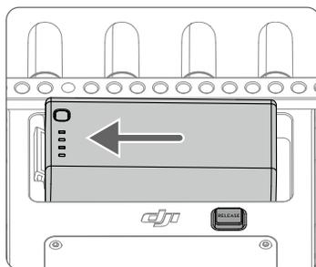
バッテリーを取り外すには、WB37バッテリー取り外しボタンを押したまま、バッテリーを反対方向に動かすと取り外せます。
