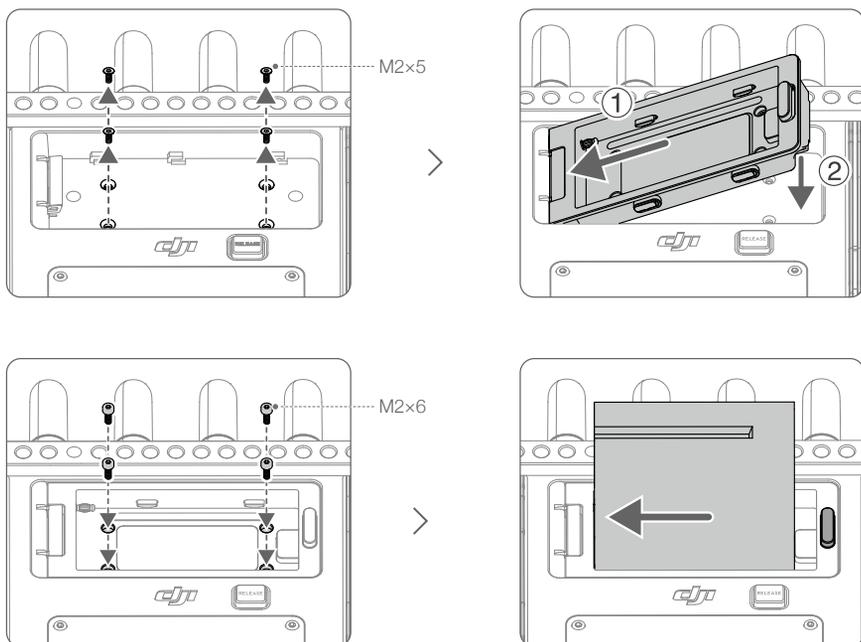
Prima continuamente o botão de libertação da bateria no adaptador da bateria e empurre a bateria na direção oposta para a remover.
