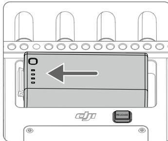
Houd de WB37 accu-ontgrendelingsknop ingedrukt en druk de accu in de tegenovergestelde richting om deze te verwijderen.
