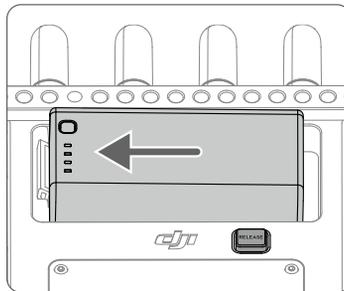
Drücke auf die WB37 Akkuentriegelung, halte sie gedrückt und drücke den Akku in die entgegengesetzte Richtung, um ihn zu entfernen.
