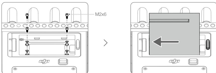
Appuyez et maintenez le bouton d'éjection de la batterie sur l'adaptateur de batterie et poussez la batterie dans la direction opposée pour la retirer.
