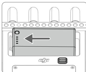
Maintenez le bouton d'éjection de la batterie WB37 enfoncé et poussez la batterie dans la direction opposée pour la retirer.
