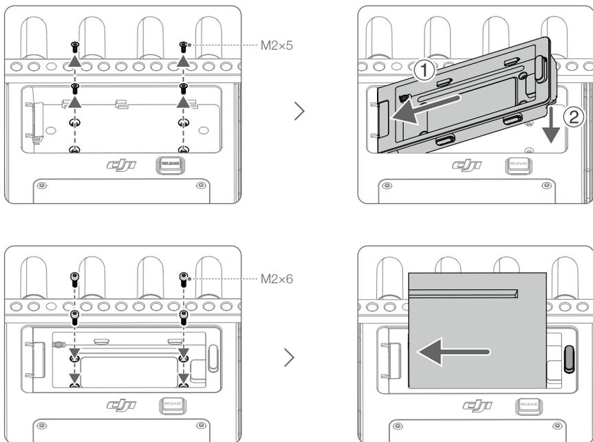
按住电池转接板上的电池移除按键，沿安装反方向用力推电池，即可取出电池。
